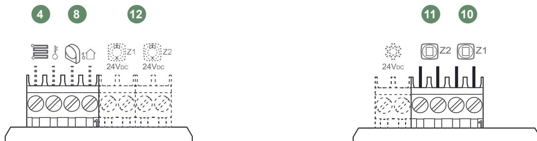
fig. 17 - Conexiones de las sondas
