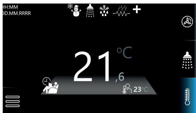
La función termostato utiliza la sonda interna e-LITE para medir la temperatura ambiente. Al activar esta función, se utilizará la sonda interna para encender o apagar la bomba de calor.
