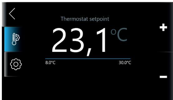
Pulsando el símbolo del engranaje, se muestran los ajustes del termostato:
